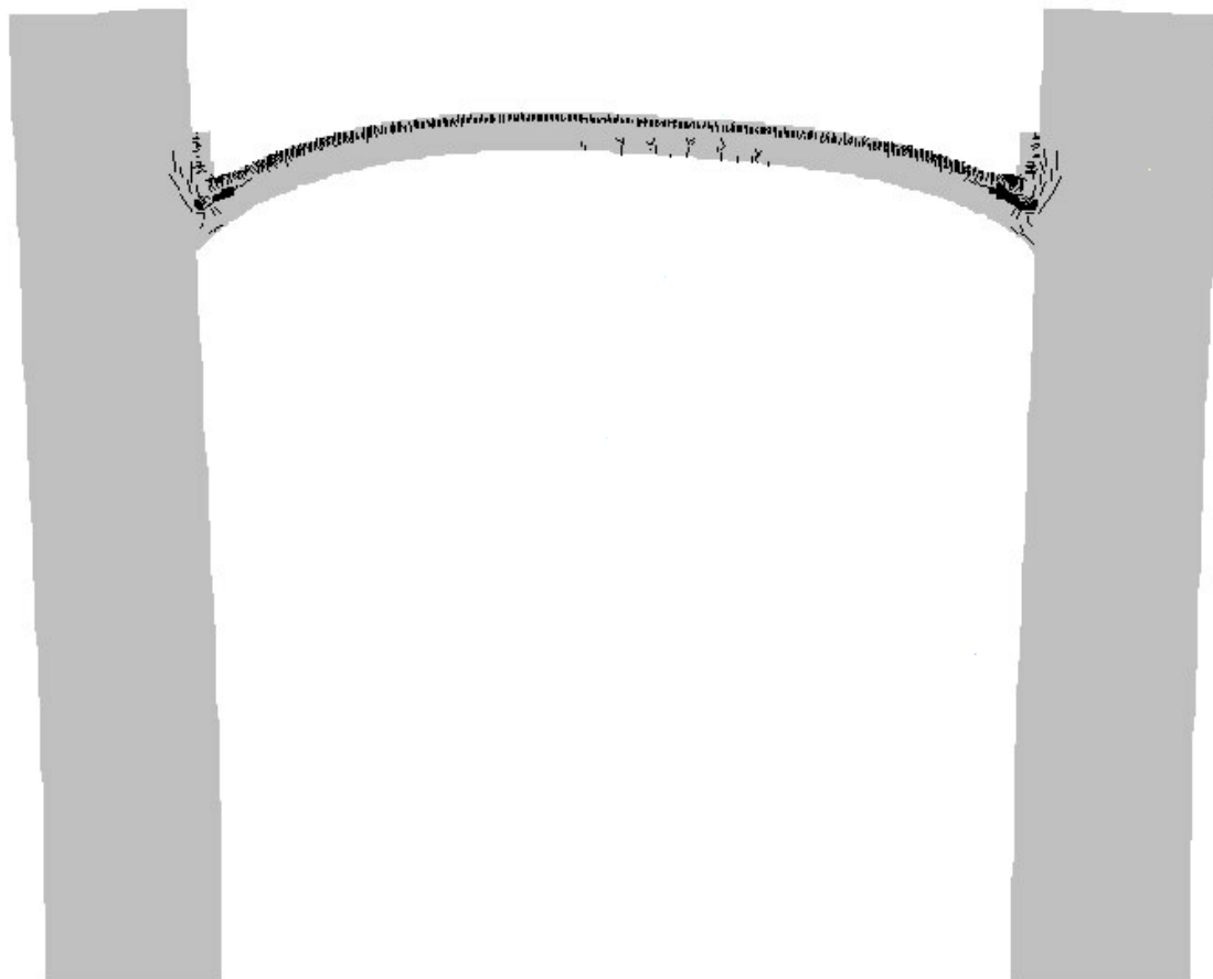
Obr. 2 Trhliny v modelu segmentové klenby zesílené 50 mm rubovou skořepinou v posledním spočteném kroku, zatížení nesymetrické, uvažován vliv smrštění
